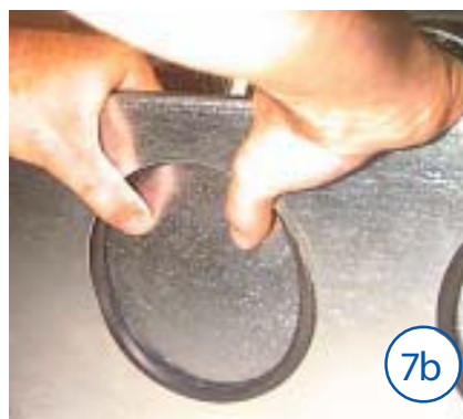
7b - A kerek zárófedelelet nyomja be.
